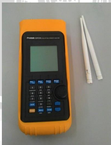
Gambar 3.6 Field strength meter dan antena router wi-fi
