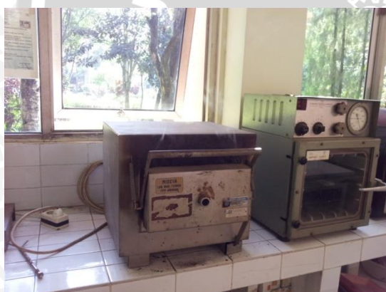
Lampiran 1.8 Oven sebagai alat pemanas untuk sampel yang akan diuji
