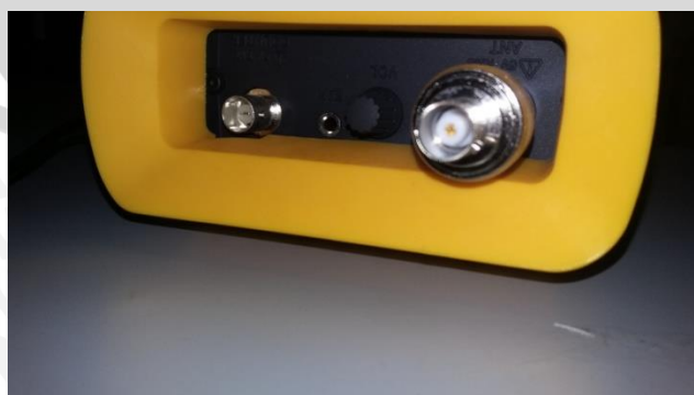
Gambar 3.9 Adaptor connector di port bagian atas pada field strength meter
