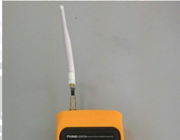
Gambar 3.10 Antena router wi-fi dipasang pada port field strength meter
