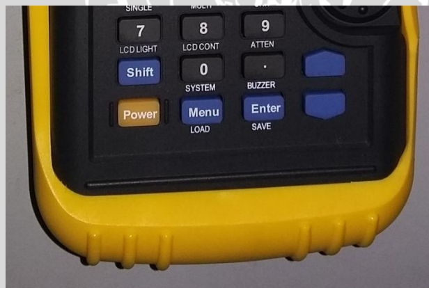
Gambar 3.11 Tombol POWER pada field strength meter
