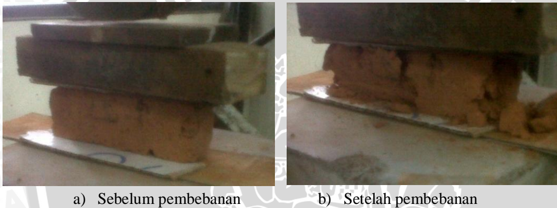
Gambar 4.3 Pengujian kuat tekan bata merah, sebelum dan sesudah pembebanan
