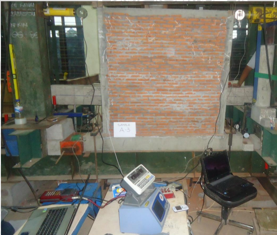
Gambar 4.13 Instalasi pengujian siklik lateral
