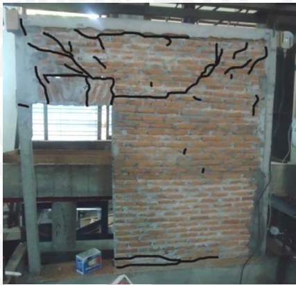
Gambar 4.37 Pola kerusakan model dinding C3 bukaan di tepi dengan kurva histeresisnya
