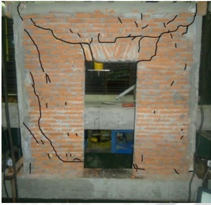
Gambar 4.27 Pola kerusakan model dinding B3 bukaan di tengah dengan kurva histeresisnya
