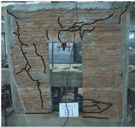
Gambar 4.21 Pola kerusakan model dinding B1 bukaan di tengah dengan kurva histeresisnya
