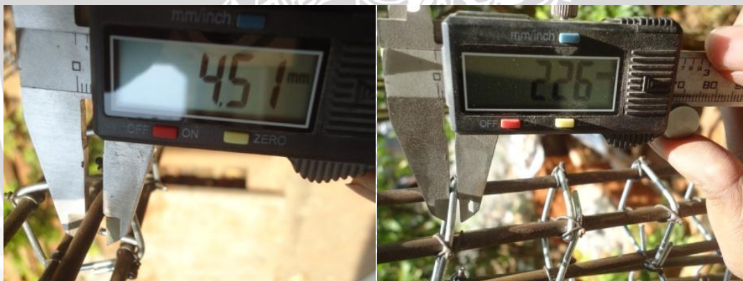
Gambar 4.11 Pengukuran diameter tulangan kolom
