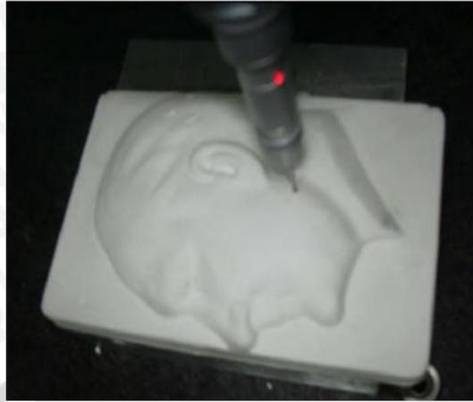
Gambar 2.2 Kontak *Scanner*
