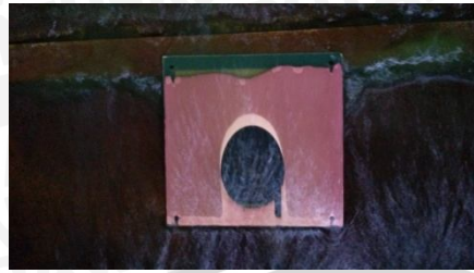
Gambar 37. Proses melarutkan tembaga pada FR4 menggunakan Ferric Chloride ( \text{FeCl}_3 )
