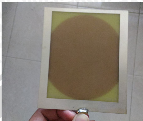
Gambar 39. Antena fabrikasi mikrostrip egg dengan slot rugby ball
