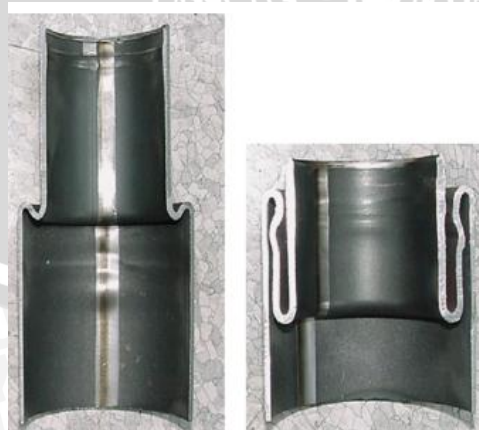
Gambar 2.10 Hydroformed Bumper Stay setelah dilakukan static-compression Sumber: Sohn (2007:285)
