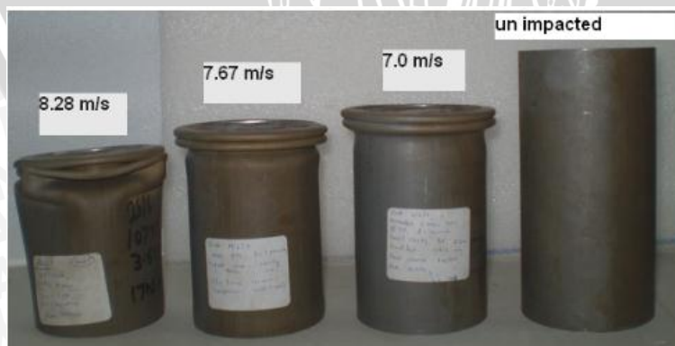
Gambar 2.6 Pola deformasi yang terbentuk pada crash box berpenampang lingkaran dengan variasi kecepatan tumbukan. Sumber: Velmurugan (2009:395)
