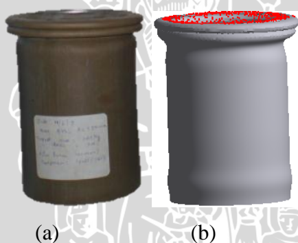
Gambar 4.1 Verifikasi Crash Box Hasil (a) Eksperimental, (b) Simulasi
