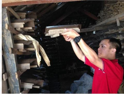
Gambar 4.7 Penyusunan Genteng Pada Rak Penyimpanan
