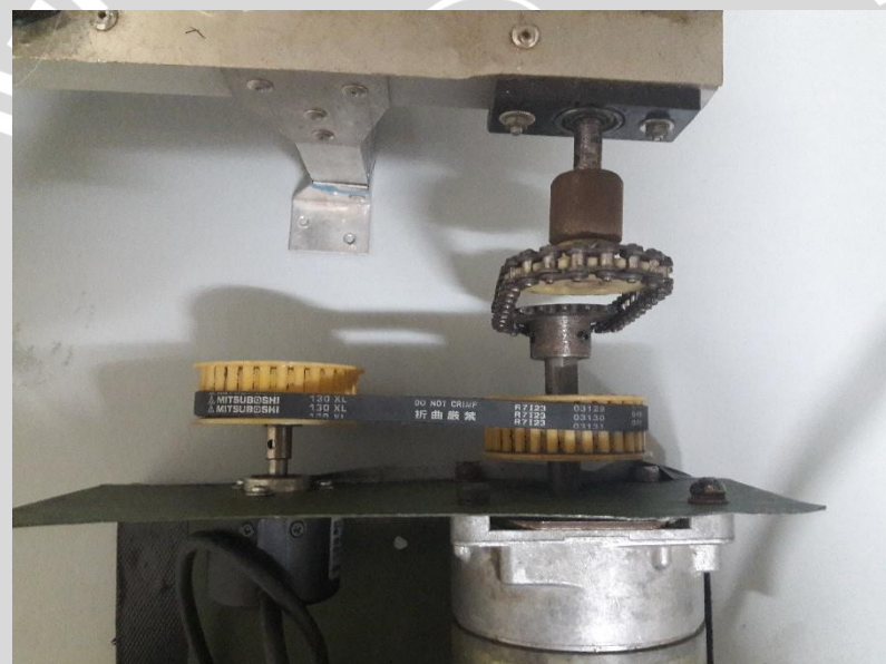
Konveyor yang telah dikopel dengan motor DC
