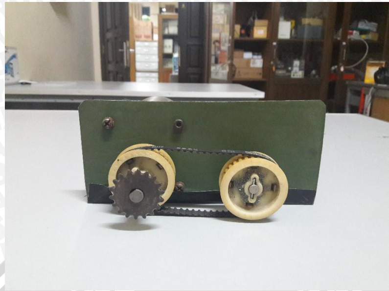
Motor DC yang telah dikopel dengan rotary encoder
