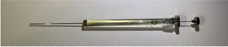
Gambar 3.1 Alat pembentuk *droplet*
