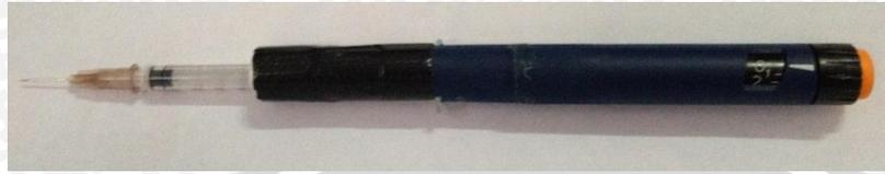
Gambar 3.1 Alat Pembentuk *Droplet*
