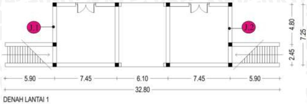
Gambar 4.61 Peletakan posisi jendela pada gapura Masjid Jamik Sumenep
