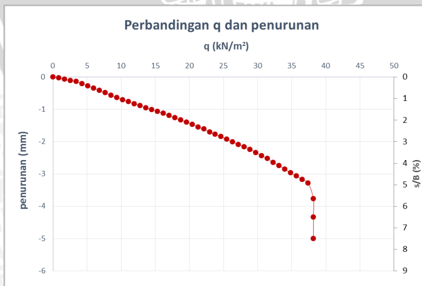
Gambar 4.23 Grafik hubungan daya dukung dan penurunan lereng tanpa perkuatan dengan B = 6 \text{ cm} dan \alpha = 56^\circ .
