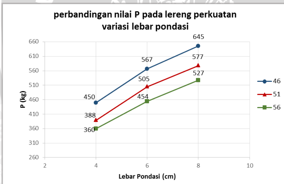
Gambar 4.62 Grafik Perbandingan Nilai Beban Runtuh Menggunakan Perkuatan Geogrid dengan Variasi Lebar Pondasi.
