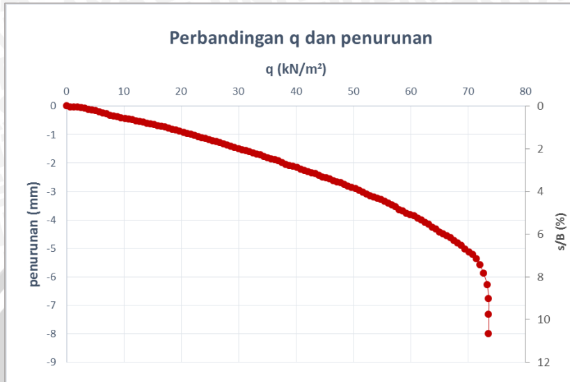
Gambar 4.36 Grafik hubungan daya dukung dan penurunan lereng dengan perkuatan dengan B = 8 cm dan \alpha = 51^\circ .
