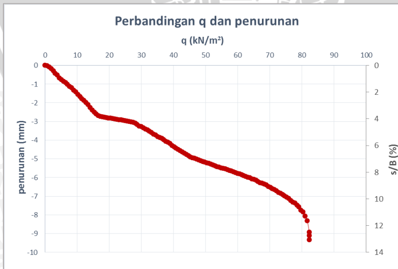
Gambar 4.33 Grafik hubungan daya dukung dan penurunan lereng dengan perkuatan dengan B = 8 cm dan \alpha = 46^\circ .
