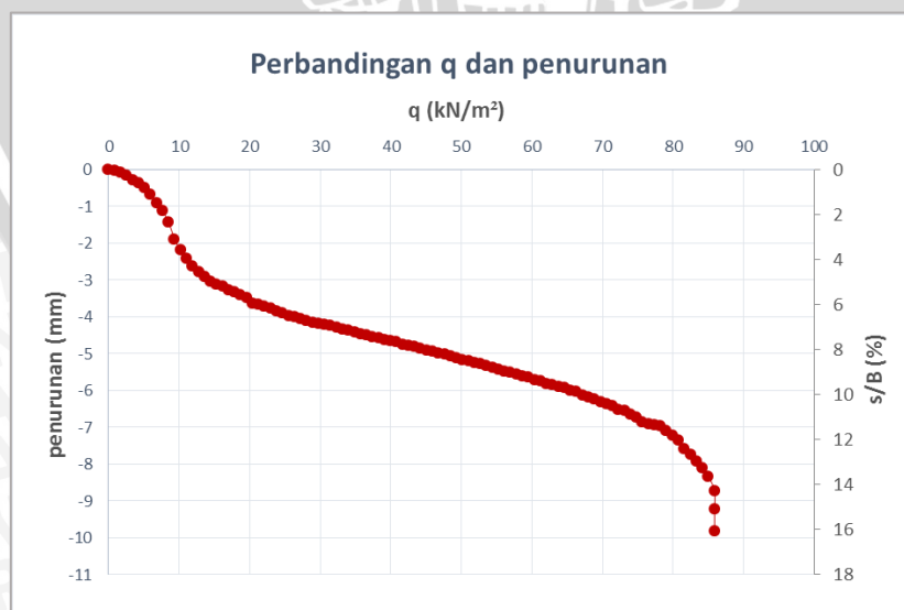
Gambar 4.35 Grafik hubungan daya dukung dan penurunan lereng dengan perkuatan dengan B = 6 cm dan \alpha = 51^\circ .
