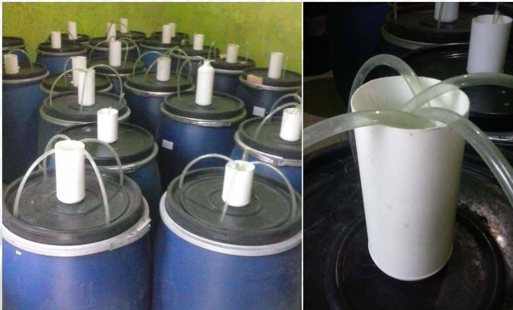
Gambar 4.6 Reaktor yang Sudah Dipasang Selang dan Botol Berisi Air
