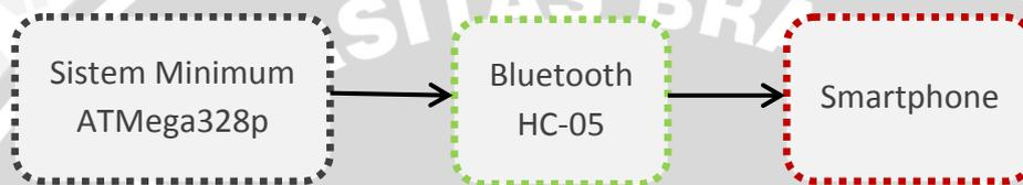
Gambar 3.14 Skema pengujian jarak komunikasi *Bluetooth* HC-05
