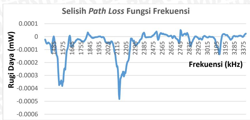
Gambar 4 Grafik selisih pengujian respon frekuensi saat tanpa bahan uji dikurangi ketika terdapat bahan uji
