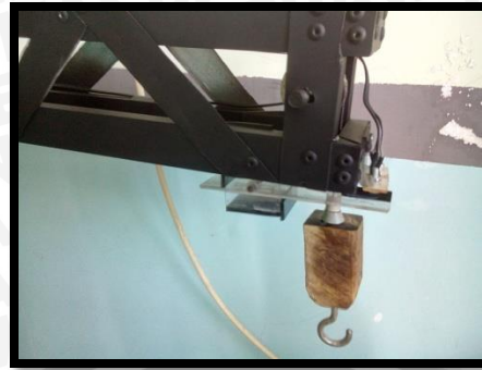
Gambar 4.5 Penempatan Sensor Optocoupler
