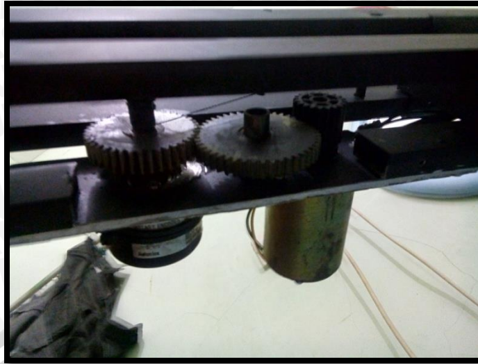
Gambar 4.3 Rotary Encoder Sejajar Dengan Motor DC
