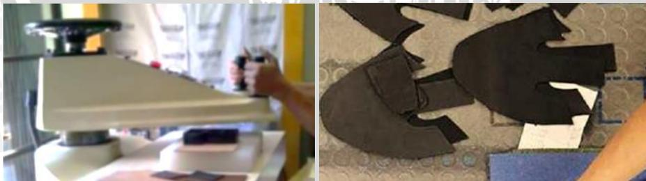
Gambar 4.3 Mesin *swing arm* dan hasil proses pemotongan komponen kulit
