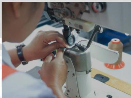
Gambar 4.8 Proses penjahitan dengan mesin jahit NPB Guide
