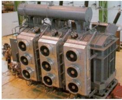
Gambar 2.7 Alat Pendingin Minyak Transformator dengan Pendinginan Paksa
