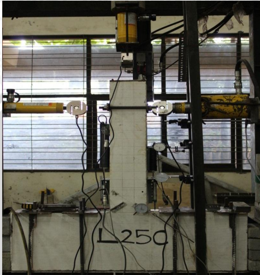
Gambar 4.2 Skema Pembebanan Kolom
