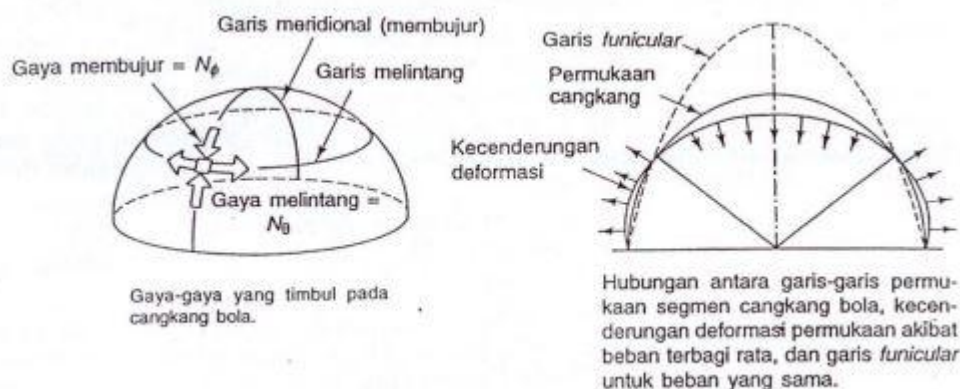
Gambar 2. 18 Gaya-gaya yang timbul pada cangkang bola
