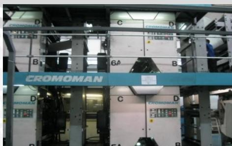
Gambar 4.3 Mesin cetak *webb offset*
