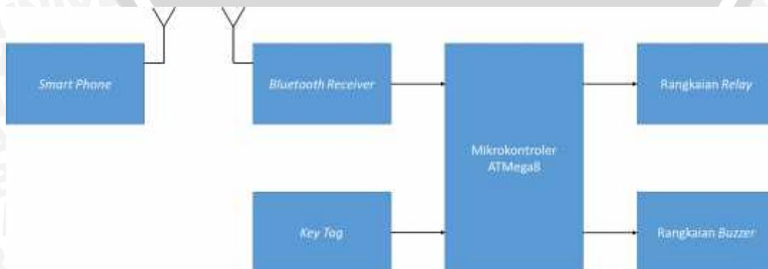
Gambar 3.1 Diagram Blok Sistem dari *Hardware*
