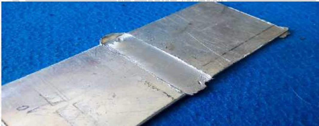
Gambar 3.8 benda kerja setelah proses pengelasan
