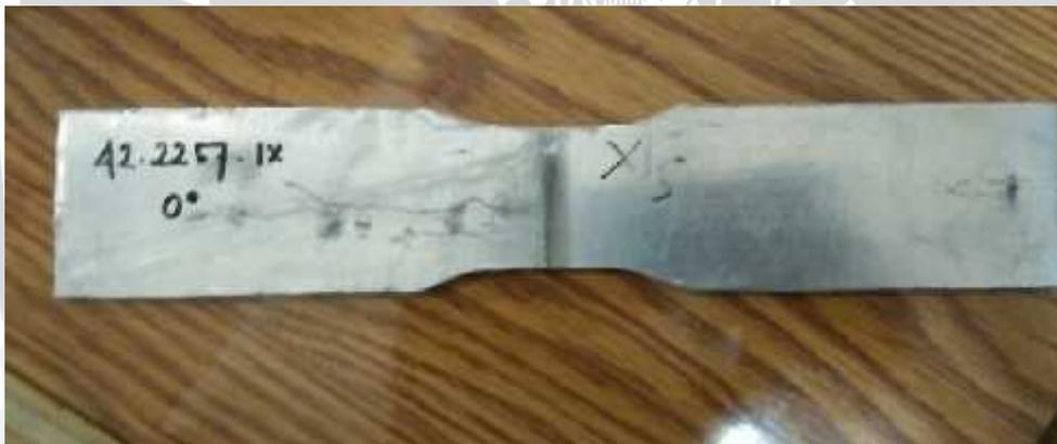
Gambar 3.12 benda kerja setelah dibentuk uji tarik
