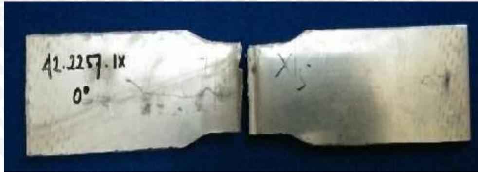
Gambar 3.13 benda kerja setelah di uji tarik
