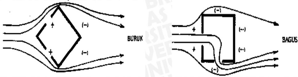
Gambar 2.11 Ventilasi dengan bukaan yang berbatasan
