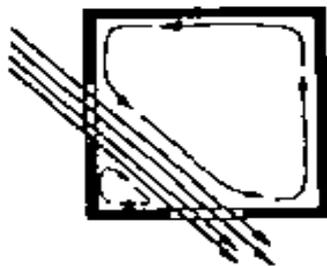
Gambar 2.13 Aliran udara pada bukaan berdekatan yang miring terhadap arah angin
