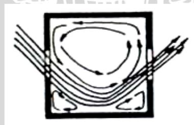
Gambar 2.8 Arah angin miring  $45^{\circ}$  dengan bukaan (inlet)
