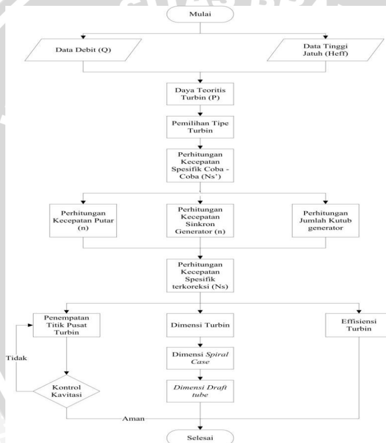
Gambar 4.26. Diagram Alir Perencanaan Turbin Hidraulik
