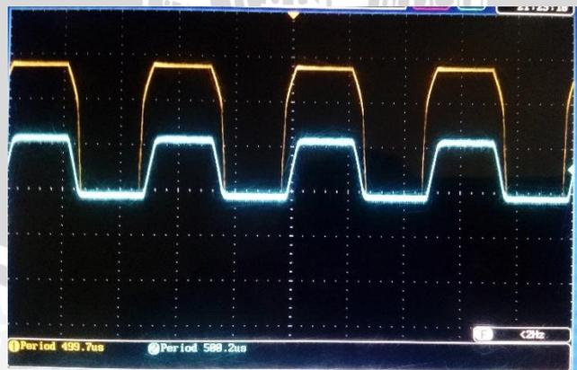
Gambar 4.17 Bentuk sinyal *input* dan *output* menggunakan 10 LED dan 1 *Photodiode*
