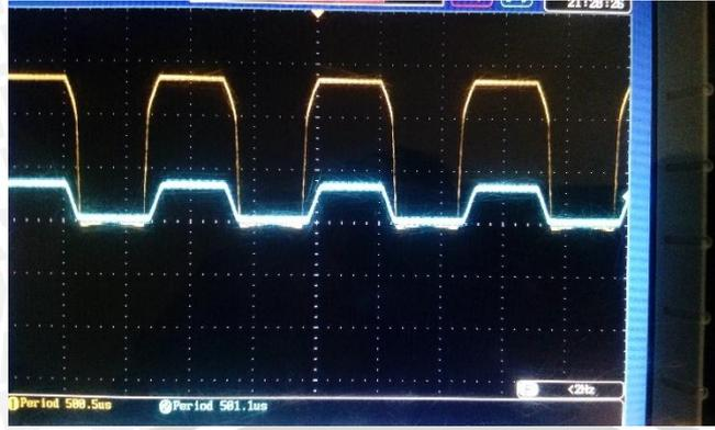
Gambar 4.18 Bentuk *signal* input dan *output* menggunakan 15 LED dan 1 *Photodiode*
