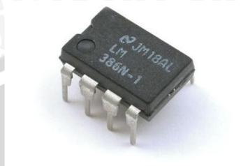
Gambar 4.2 *Amplifier* IC LM386
