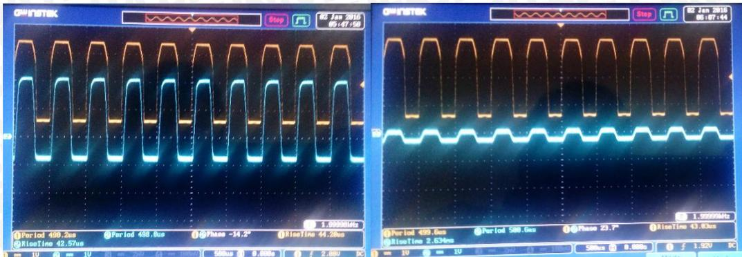
Gambar 4.18 Contoh Pengamatan *Delay Spread* pada jarak 10 cm (kiri) dan 50 cm (kanan)
