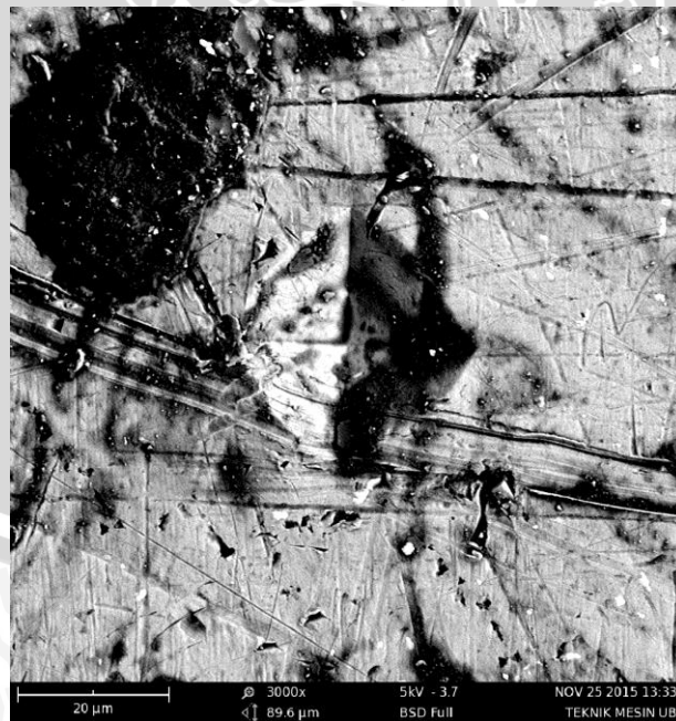
Gambar 4.3 Bekas Titik Indentasi dengan Power Input 60 watt (perbesaran 3000x)
