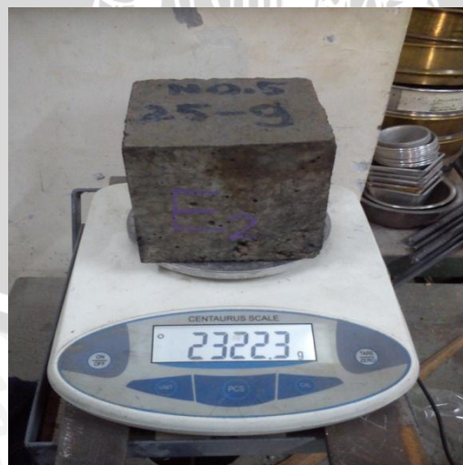
Gambar L.12.17 Penimbangan Benda Uji Setelah Dilap Permukaannya
