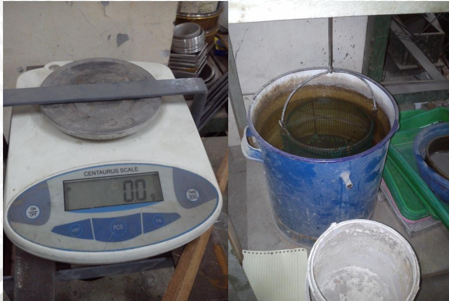
Gambar L.12.18 Persiapan Penimbangan Benda Uji di dalam Air
