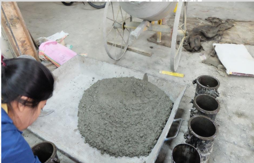
Gambar L.12.8 Beton Setelah Proses Pencampuran
