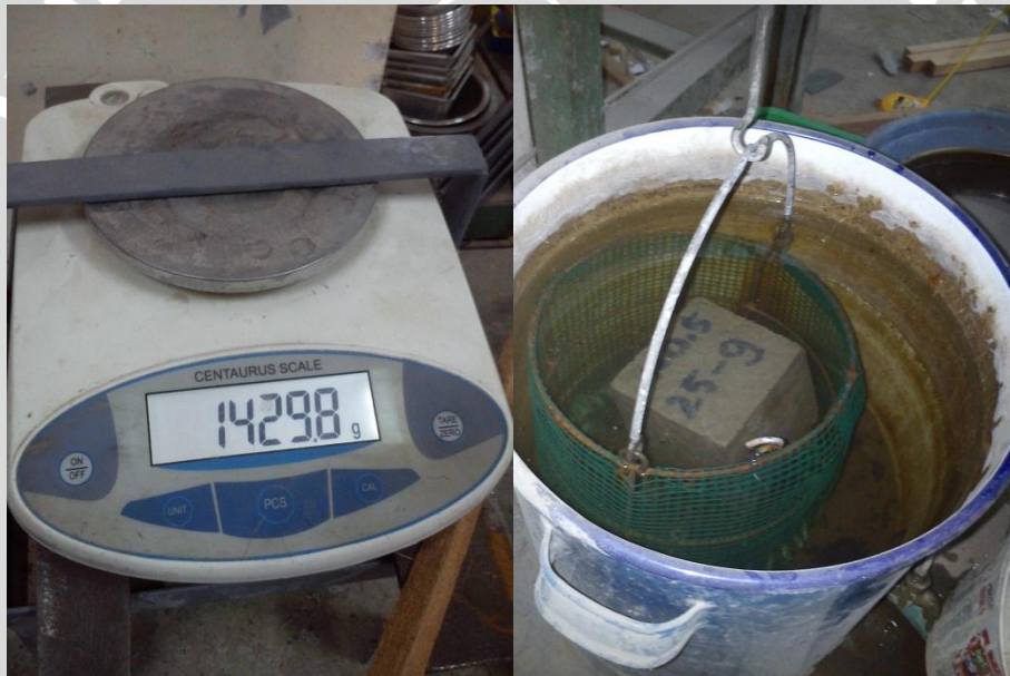
Gambar L.12.19 Penimbangan Benda Uji di dalam Air
