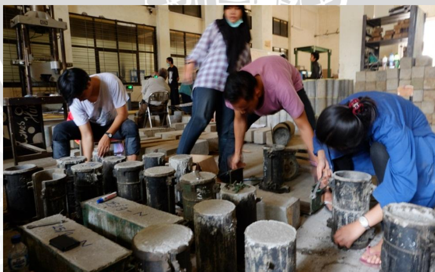
Gambar L.12.11 Pelepasan Cetakan Setelah 24 jam
