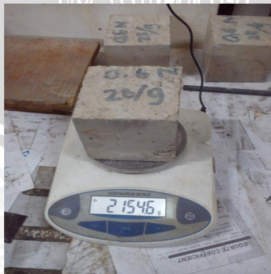
Gambar L.12.14 Penimbangan Benda Uji Setelah Dioven
