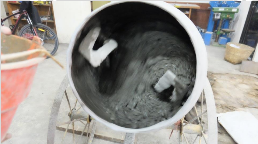
Gambar L.12.7 Pencampuran Semen, Pasir, Batu Onix, dan Air Pada Molen
