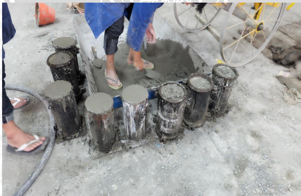
Gambar 14 : Pembuatan Benda Uji dengan Cetakan Silinder
