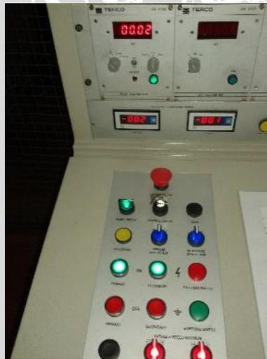
Gambar 16. Alat ukur tegangan tinggi impuls pada control desk
