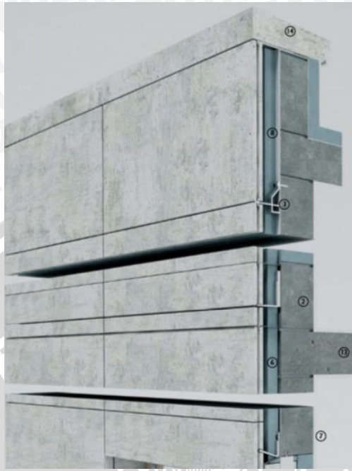
Gambar 2.39 Dinding Batu yang Telah dibentuk Menjadi Panel
