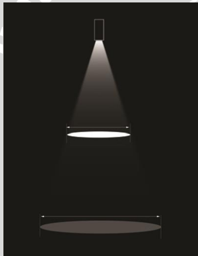
Gambar 2.26 Perbedaan Ketinggian Menghasilkan Diameter Sorot yang Berbeda
