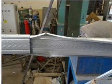
Gambar 10 Model keruntuhan pada model 2
