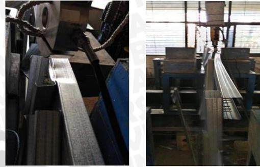
Gambar 8 Model 1 mengalami keruntuhan di profil
