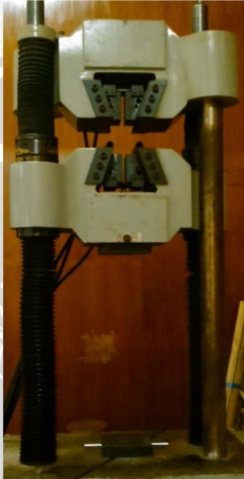
Gambar 3.8 Mesin Uji Tarik
