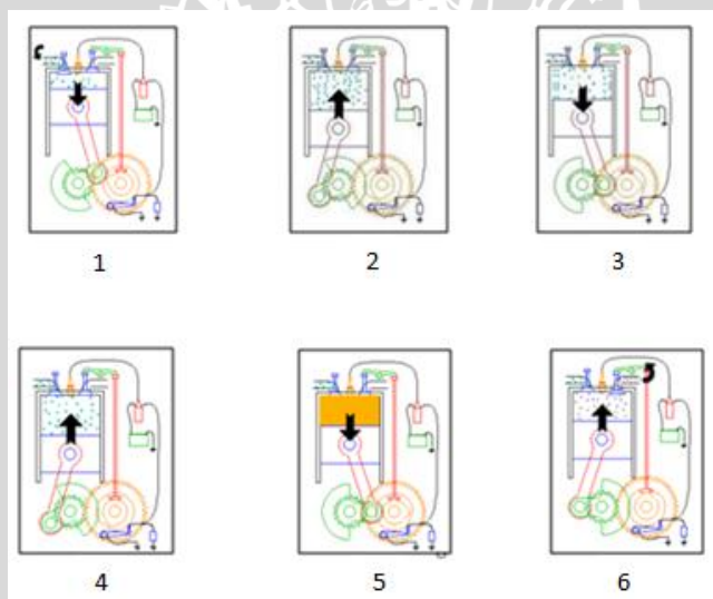
Gambar 2.4 : Skematis siklus motor bakar 6 langkah berbasis difusi Sumber : Noor , 2015
