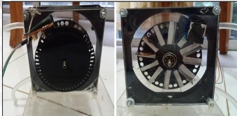
Gambar 3. 9 Mini Steam Turbine
