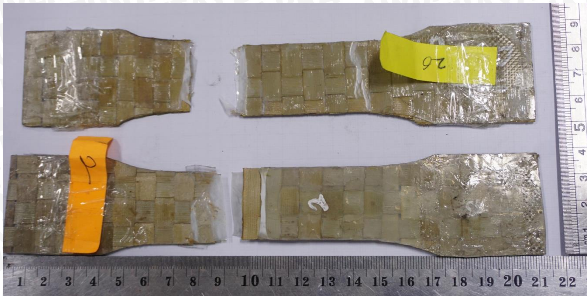
Gambar 4.7 foto tampak atas bentuk patahan spesimen uji tarik (2) spesimen 0^{\circ}/90^{\circ} tanpa penekanan (26) spesimen 0^{\circ}/90^{\circ} dengan diberi tekanan 40 \text{ kg/cm}^2 dan waktu tekan 15 detik
