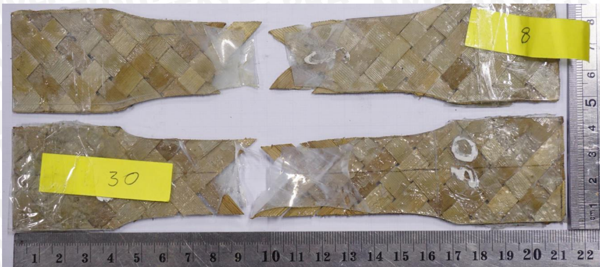
Gambar 4.12 foto tampak atas bentuk patahan spesimen uji tarik (30) spesimen 45^{\circ}/-45^{\circ} tanpa penekanan (8) spesimen 45^{\circ}/-45^{\circ} diberi tekanan 60 \text{ N/mm}^2 dan waktu penekanan 15 detik
