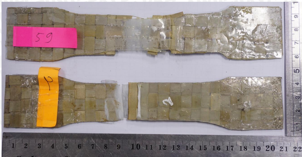
Gambar 4.17 foto tampak atas bentuk patahan spesimen uji tarik (2) spesimen 0^{\circ}/90^{\circ} tanpa perlakuan penekanan (59) spesimen 0^{\circ}/90^{\circ} dengan diberi penekanan 60 \text{ kg/cm}^2 dan waktu tekan 30 detik.
