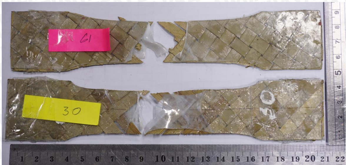
Gambar 4.22 Foto tampak atas bentuk patahan spesimen uji tarik(30) sudut 45^{\circ}/-45^{\circ} tanpa perlakuan penekanan (61) spesimen sudut 45^{\circ}/-45^{\circ} dengan perlakuan penekanan 60 \text{ N/mm}^2 dan waktu penekanan 15 detik
