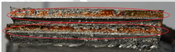
Gambar 9. Foto Makro Spesimen Setelah Uji Tarik Putaran Spindle 2906
