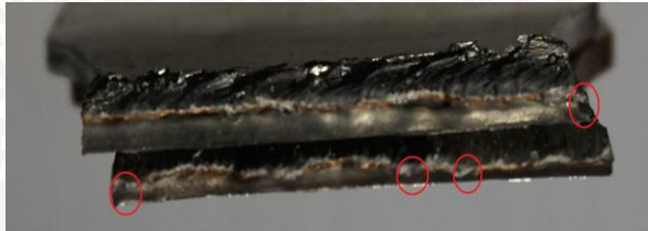
Gambar 7. Foto Makro Spesimen Setelah Uji Tarik Putaran Spindle 1842
