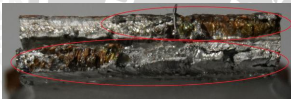
Gambar 8. Foto Makro Spesimen Setelah Uji Tarik Putaran Spindle 2257
