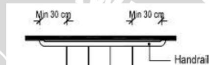
**Gambar 2. 15. Handrail pada Tangga**
