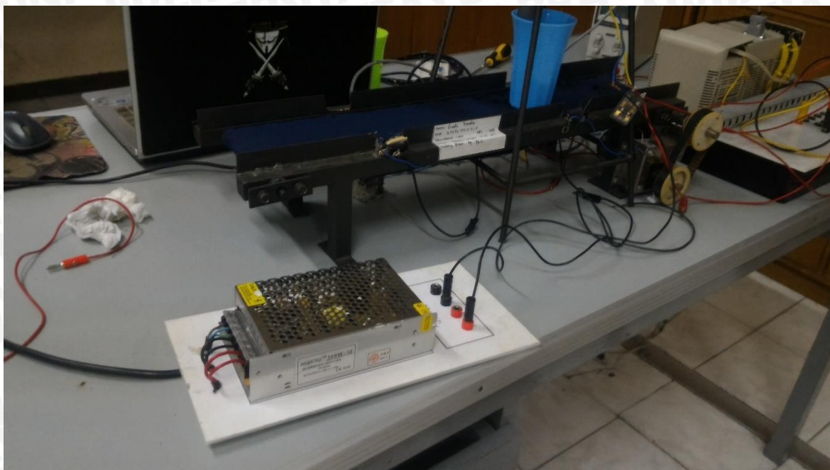
Gambar hubungan lengkap filling plant dengan PLC CQM1 dan Laptop
