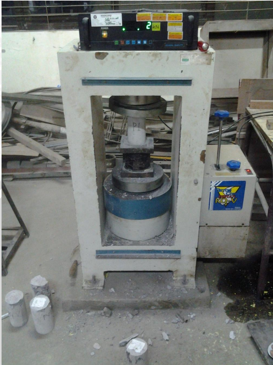
Gambar 3. Uji tekan silinder agregat pumice
