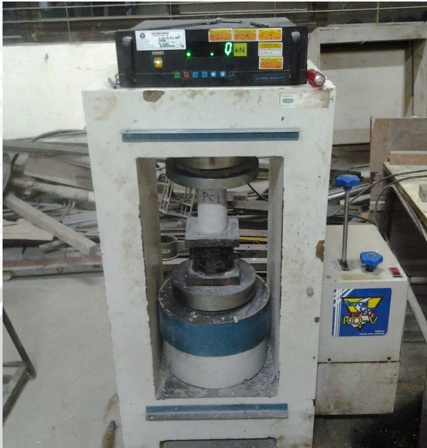
Gambar 2. Uji tekan silinder agregat pumice cat
