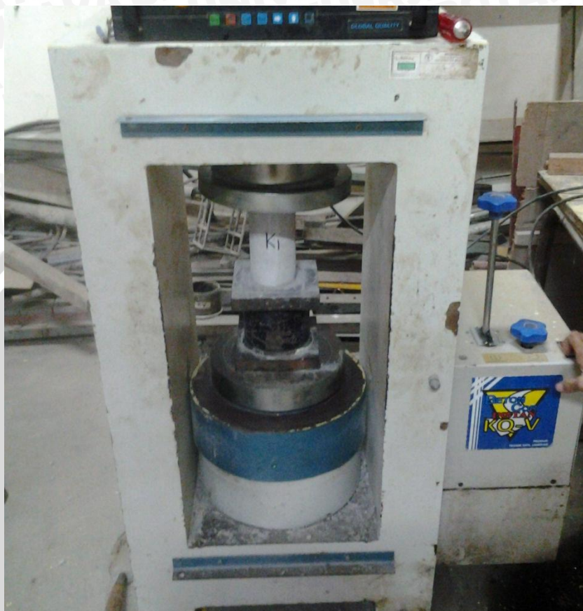
Gambar 1. Uji tekan silinder agregat kerikil
