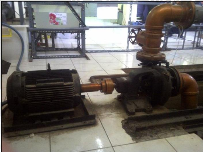
Gambar 3.1 Pompa Sentrifugal.
