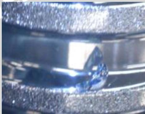
Gambar 1.1b Cacat Jenis Lengketan Sisa Material
