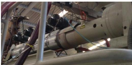
Gambar 4.9 *Barel* Mesin *Blow Moulding*
