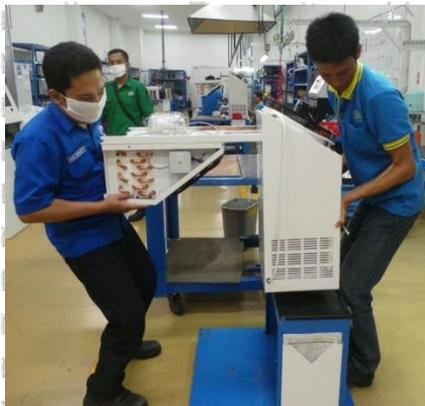
Gambar 4.13 Operator Meletakkan Unit GEK di Kereta *Testing*
