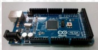
Gambar 4.2 Mikrokontroler Arduino Mega 2560
