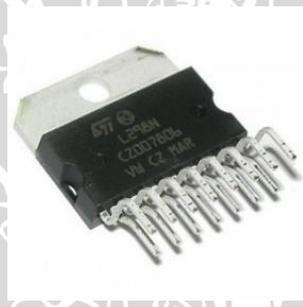
Gambar 2.7 IC *driver* Motor L298N
