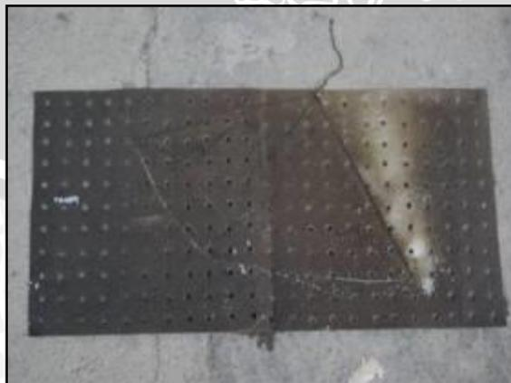
Gambar 3.7. *Diffuser Plate* dari Bahan Seng
