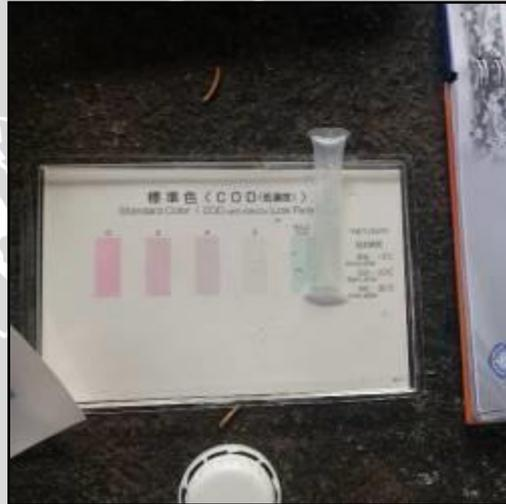
Gambar 3.22. Proses Pengukuran COD
