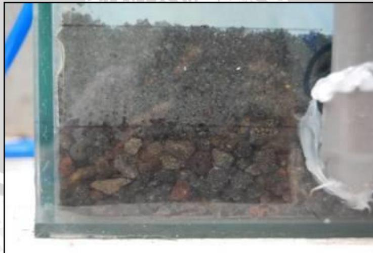
Gambar 3.11. Media Pembatas dan Penyangga di dalam Unit *Biosand Filter*
