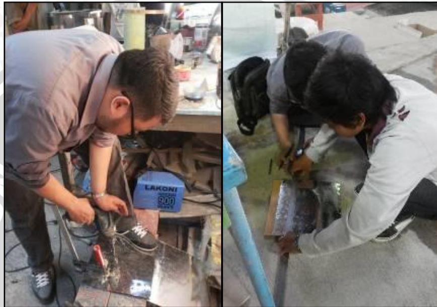
Gambar 3.14. Proses Pembuatan *Diffuser Plate*
