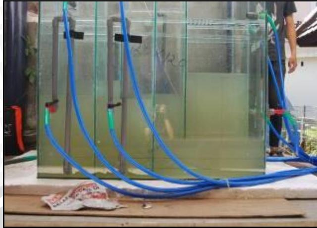
Gambar 3.16. Pengisian Air ke dalam Unit *Biosand Filter*
