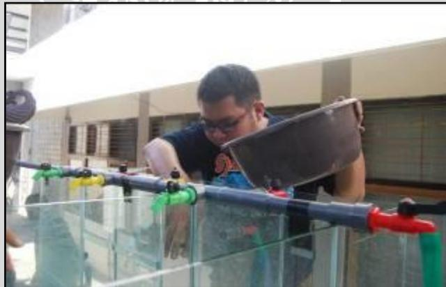
Gambar 3.17. Proses Memasukkan Media ke dalam Unit *Biosand Filter*
