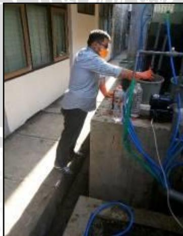
Gambar 3.21. Proses Pengambilan Sampel Air Limbah yang akan Diujikan
