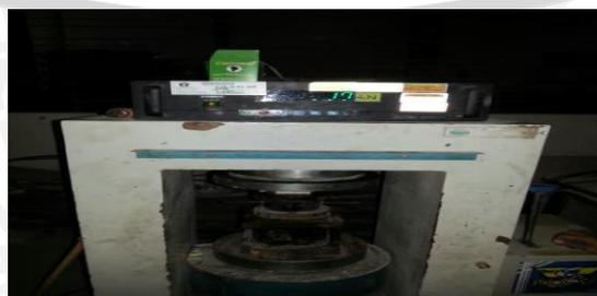
**Gambar 4.8** Pengujian Kuat Tekan Gypsum Menggunakan *Compressive Strength Testing Machine*
