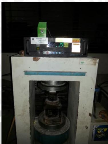
Gambar Proses Pengujian Kuat Tekan pada Gypsum
