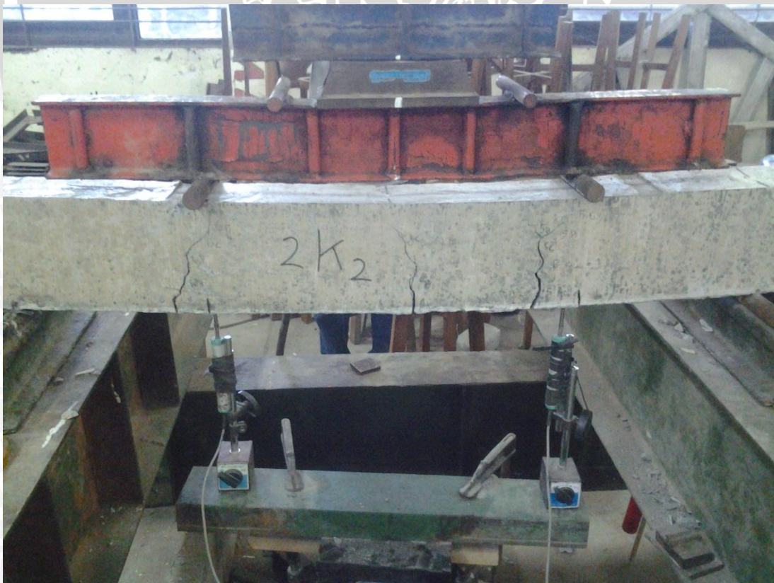
Gambar 9. Uji pembebanan beton agregat kerikil 2
