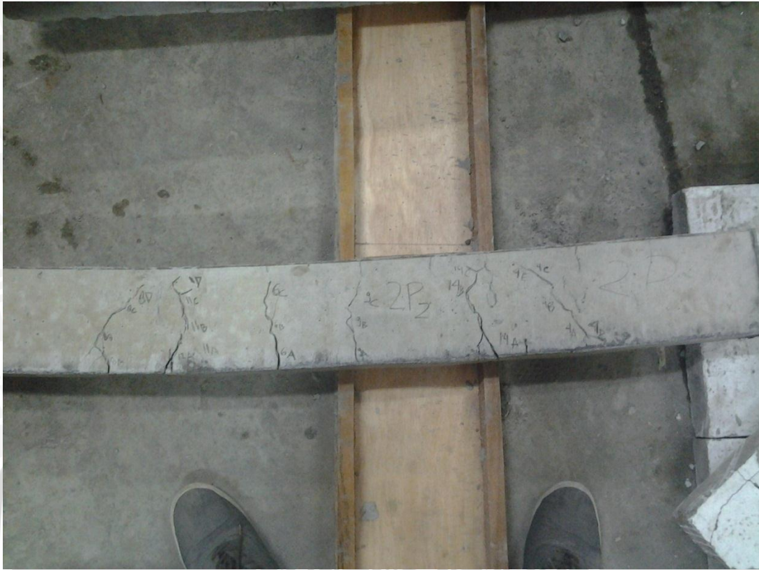
Gambar 12. Uji pembebanan beton agregat pumice 2
