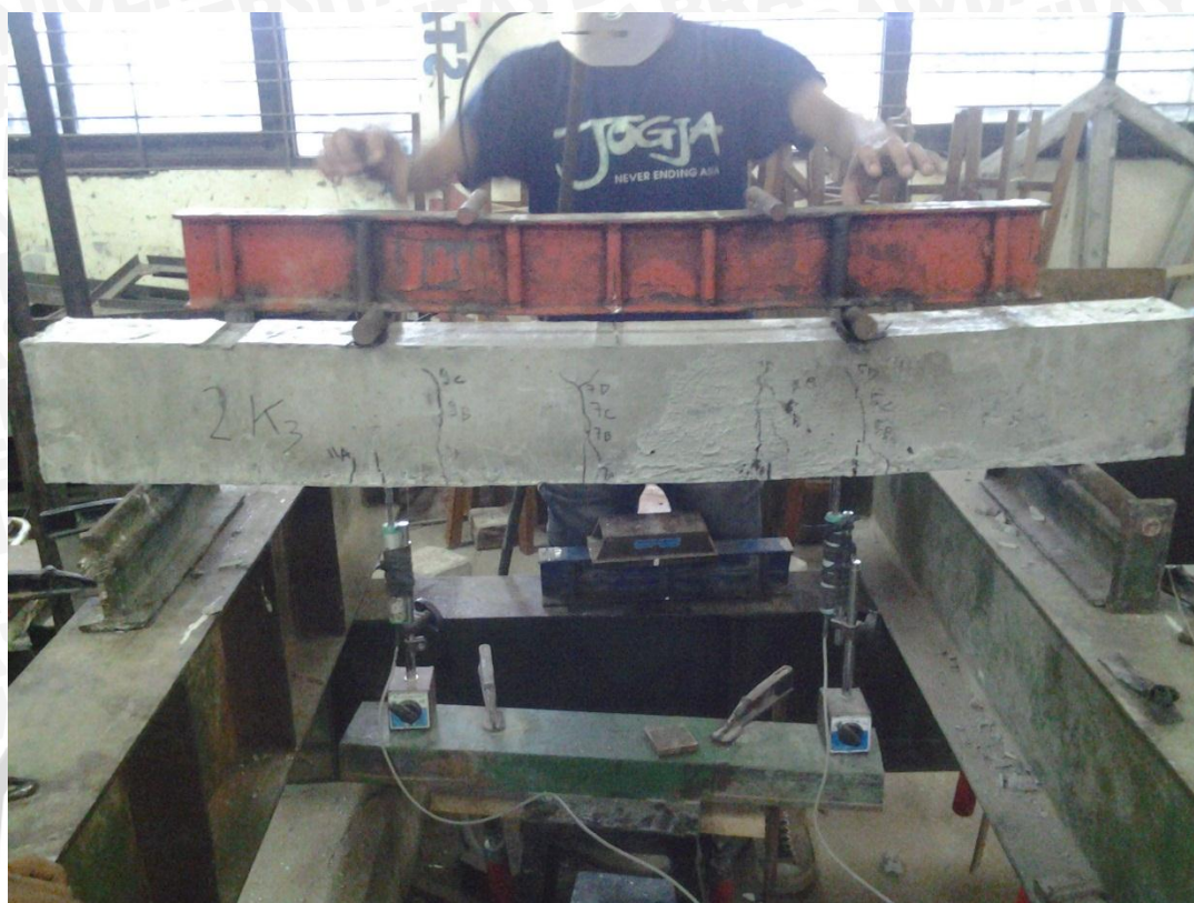
Gambar 10. Uji pembebanan beton agregat kerikil 3
