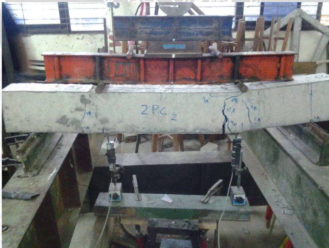
Gambar 15. Uji pembebanan beton agregat pumice cat 2
