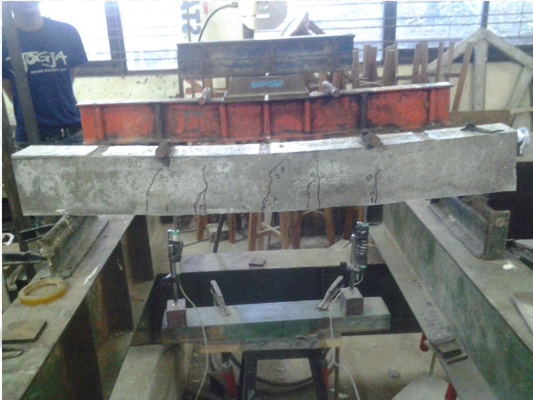
Gambar 8. Uji pembebanan beton agregat kerikil 1
