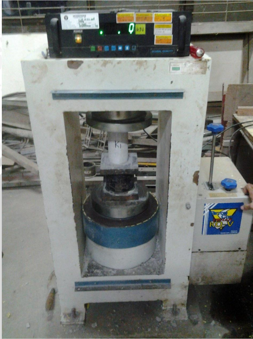
Gambar 5. Uji tekan silinder agregat kerikil
