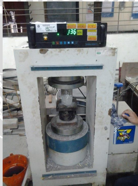
Gambar 4. 2 Pengujian Kuat Tekan Sampel Beton
