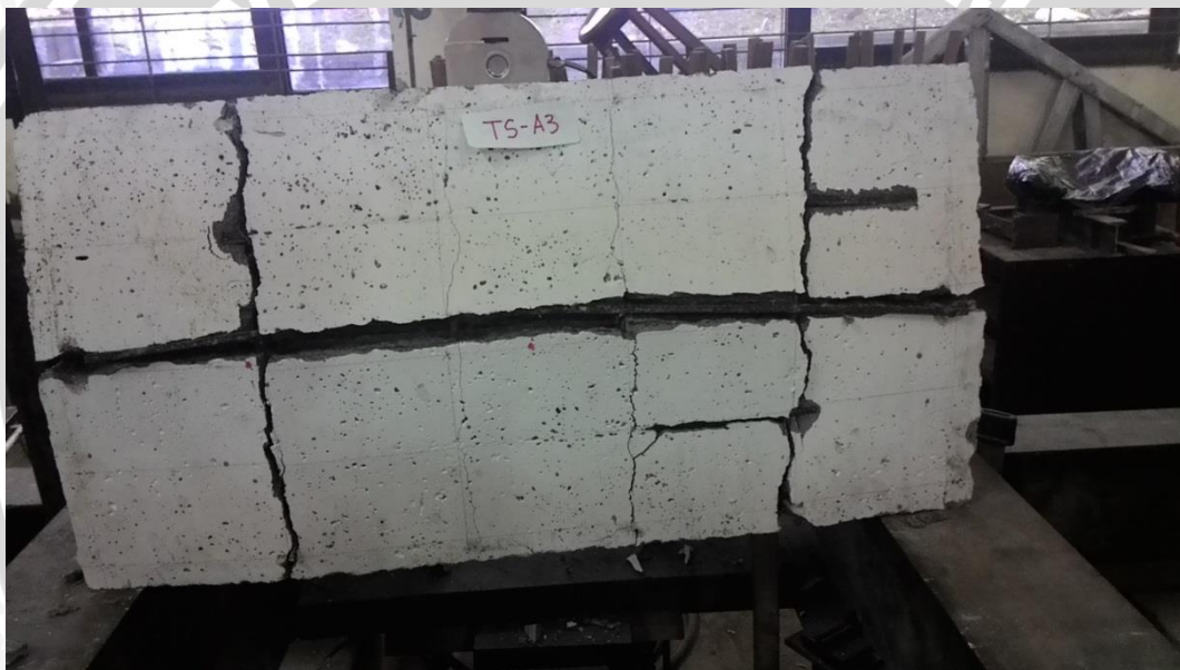
Gambar 4. 16 Pola Retak Bagian Bawah Plat TS-A3
